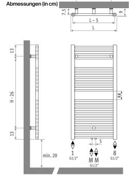
Werkdruck: max. 16 bar (1600 kPa)
